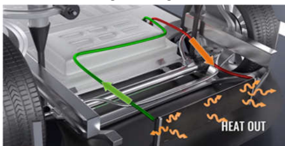
Hình 1. Hình ảnh đường ống nước làm mát cho pin
